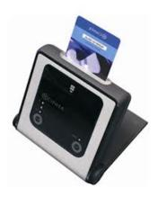
Das nCipher nShield Edge ist ein HSM mit USB Schnittstelle. Als Mitglied der nCipher HSM Familie bietet das Edge vollständige HSM Funktionalität mit Chipkartenleser und Quorum Authentifizierung für den Schutz des sensitiven Schlüsselmaterials. Das Edge ist für kleine Transaktionsvolumen geeignet.
